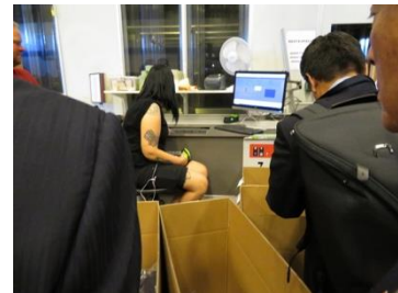
(写真: アソート中の作業員。ビンが順番に出てくるので指示数をピックアップして、店舗別の段箱に投入するのみ)
